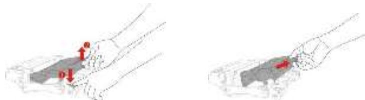
3. 打开新的鼓组件包装，取下鼓组件保护装置，将鼓组件放置于水平台面。
