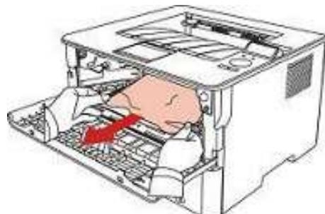
7. 取出卡纸后，重新装入激光碳粉盒，合上前盖，打印机将恢复打印。
