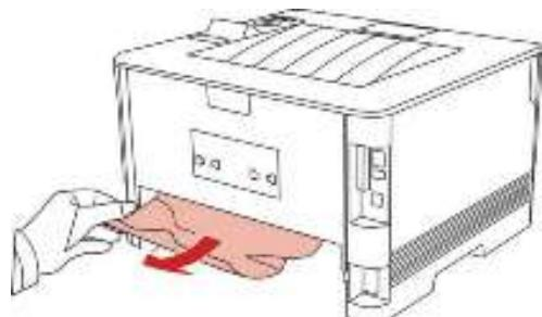
4.取出卡纸后，装回双面打印单元，检查产品其他部位，确保无卡纸后，开合前盖，打印机将自动恢复打印。
