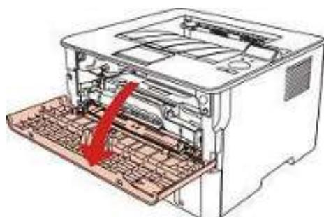
5. 沿着导轨取出激光碳粉盒。(为避免感光鼓曝光影响打印质量,请用保护袋将激光碳粉盒装好,或用厚纸包裹激光碳粉盒。)
