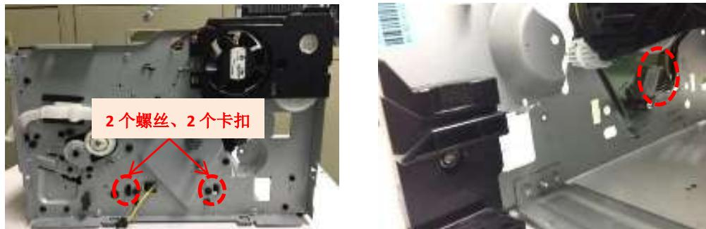
2. 拆下右侧框体螺丝 5 个，取下右框体，拆下马达螺丝 3 个，取下马达。
