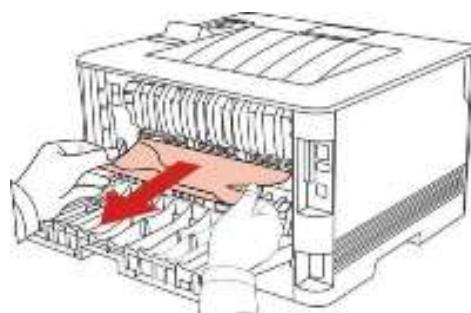
4.取出卡纸后，关上后盖，开合前盖，打印机将自动恢复打印。
