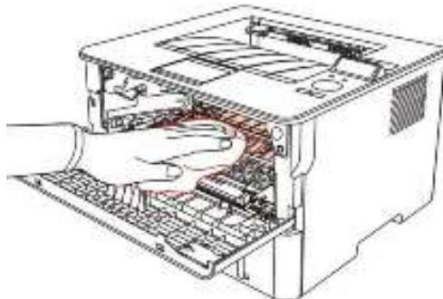
5. 用干燥无绒布料轻轻擦拭打印机 LSU 镜片。
