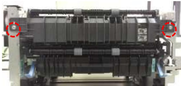
2. 拆下数据板上、电源板上插头 3 处，拆下定影螺丝 5 个，取下定影器。
