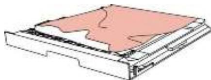
3.如果纸张未随双面打印单元一起出来，请打开纸盒直接从底部取出卡纸。
