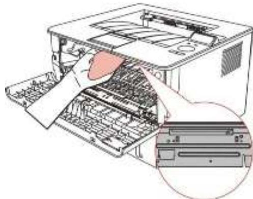
6. 打开打印机的自动进纸盒，用干燥无绒布料轻轻擦拭打印机搓纸辊。
