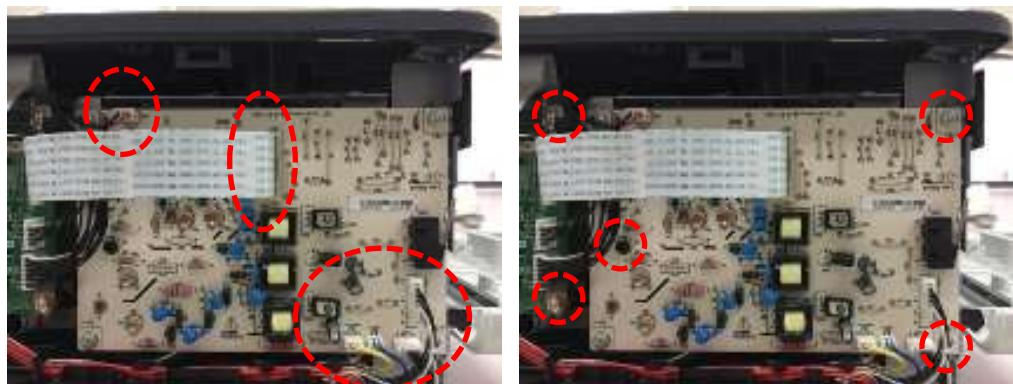
**注：**取下引擎基板后，会看到 4 个导电弹簧（拆完后容易脱落），请注意保存好，切勿丢失。安装时请注意导电弹簧不要装错位置，4 个导电弹簧中最下面的导电弹簧与其它 3 个不同。
