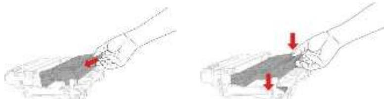
5. 拿起安装完粉盒的鼓组件，沿着打印机内导轨装入已安装了粉盒的鼓组件，完成安装，
