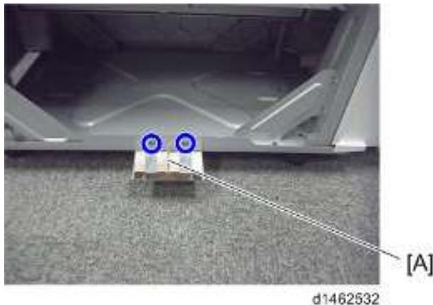
16. 将最终加工器适配器[A]随附的连接支架固定到最终加工器 ( $\text{M}4 \times 25$ : 最终加工器适配器随附)。
