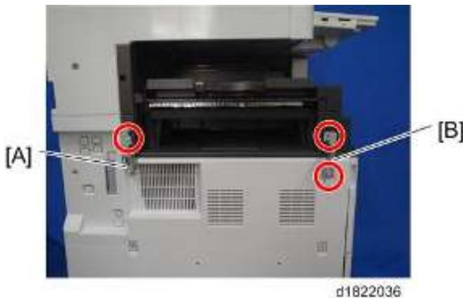
18. 利用连接杆[A]将最终加工器连接到机器 ( $\text{M}4 \times 1$ )。
