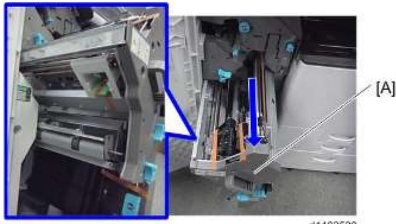
6. 打开最终加工器顶盖板[A]。
