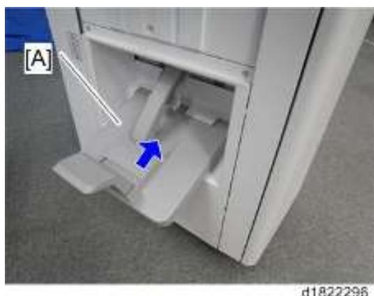
14. 将最终加工器适配器[A]随附的中继导板固定到最终加工器 ( $\text{M}3 \times 2$  ( $M3 \times 6$ ) )。不得使用最终加工器随附的中继导板。
