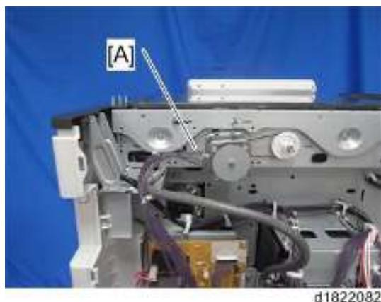
6. 拆除扫描仪电机单元[A] (x2, x1) 。
