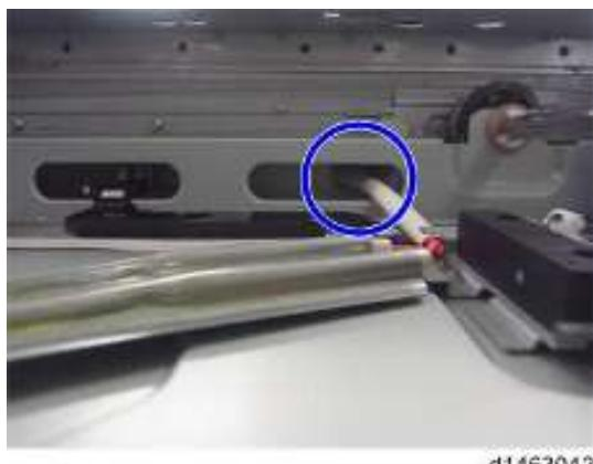
9. 打开固定主机导线[A]的一个线夹，将导线与加热器导线相连。
