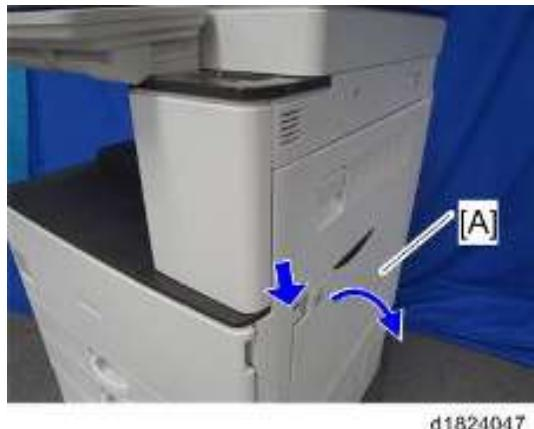
2. 拆除手动纸盘右盖板[A] (扳手x2)。
