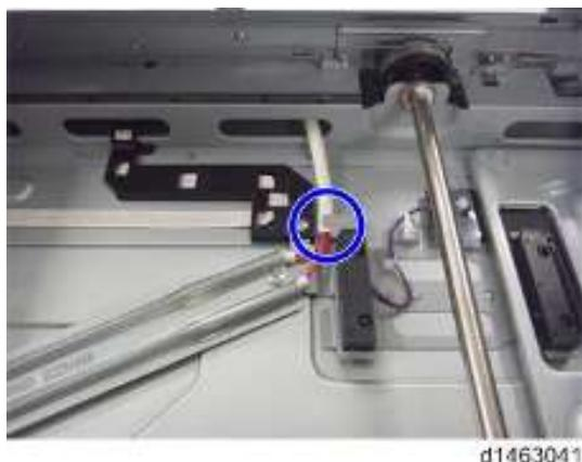
8. 将导线穿过框架中的小孔。
