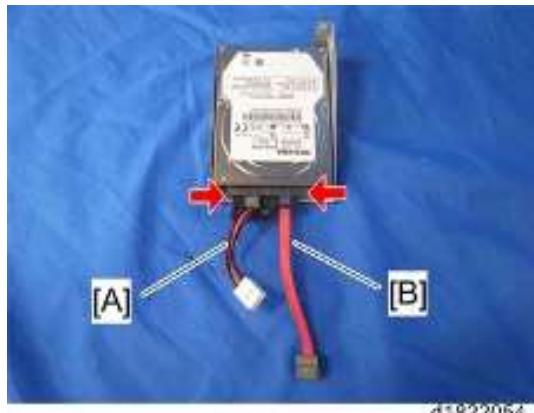
3. 将 HDD [A]悬挂在控制器盒的钩子[B]上并进行固定 (x3)。
