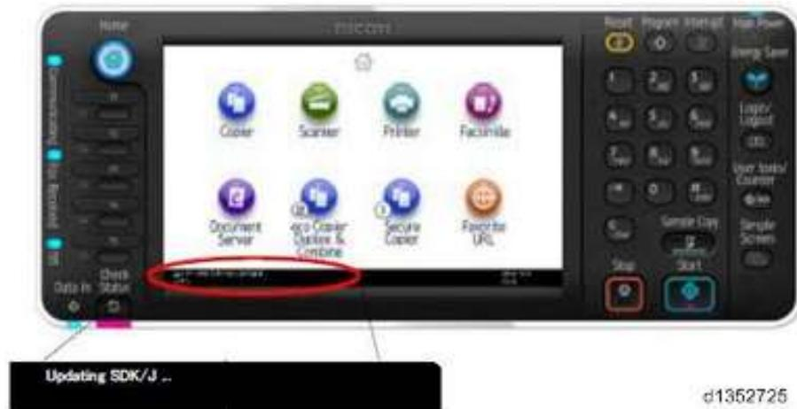
4. 更新完成时，触摸面板显示屏的标题信息中将出现“更新 SDK/J 成功”。关闭电源后，从插槽移除 SD 卡。
