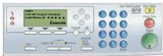
6. 显示“载入状态…”时，不要触摸任何键。此消息表示程序正在运行。
