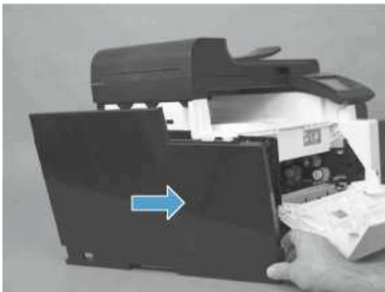
图 1-33 拆除右盖板（第 6 张，共 6 张）
