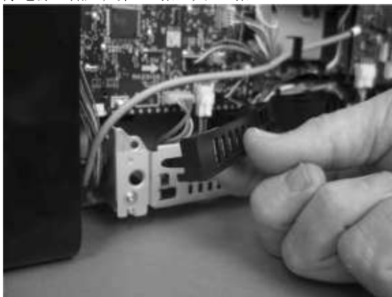
图 1-105 拆除电源（低压；第 4 张，共 8 张）
