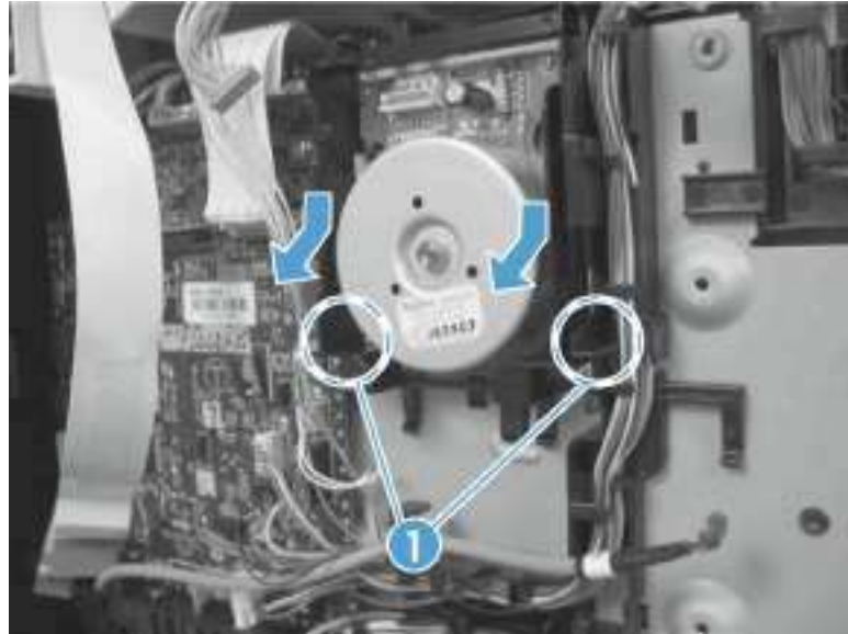
图 1-85 拆除主电机（第 2 张，共 4 张）
