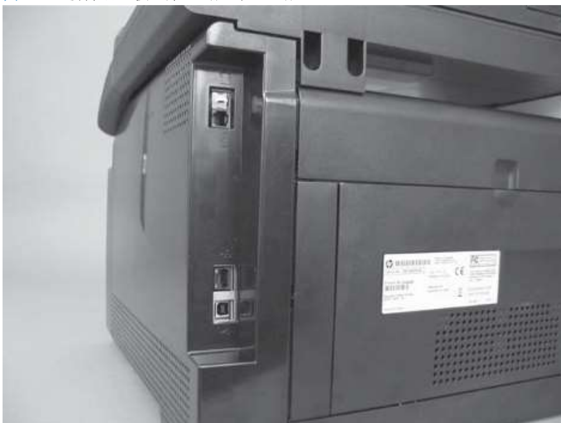
图 1-16 拆除右盖板（第 3 张，共 5 张）
