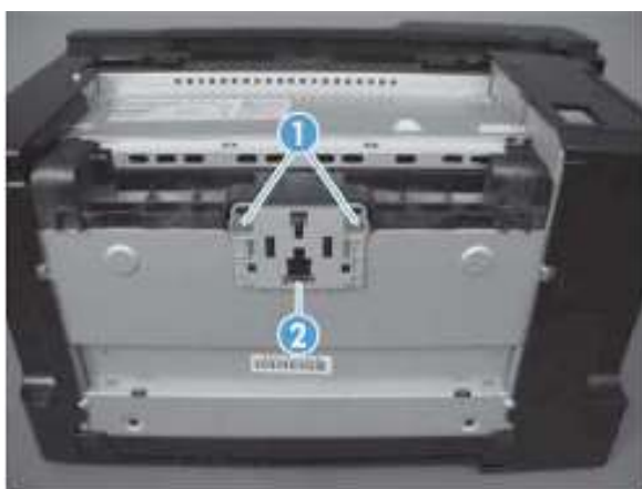
图 1-12 拆除打印机主体分离垫装置
