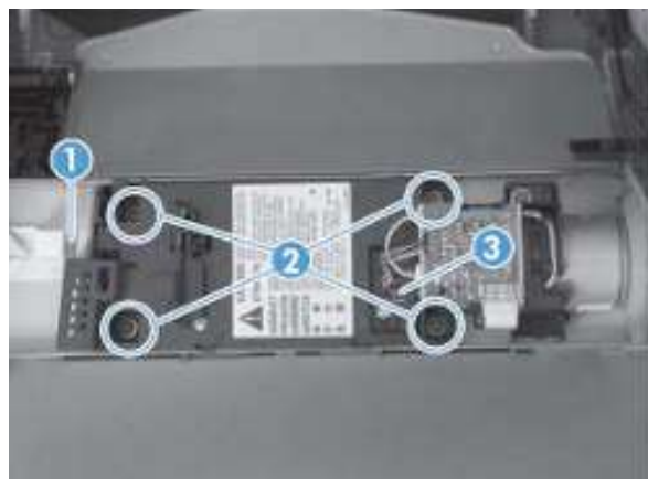
图 1-104 拆除激光/扫描仪装置（第 3 张，共 3 张）
