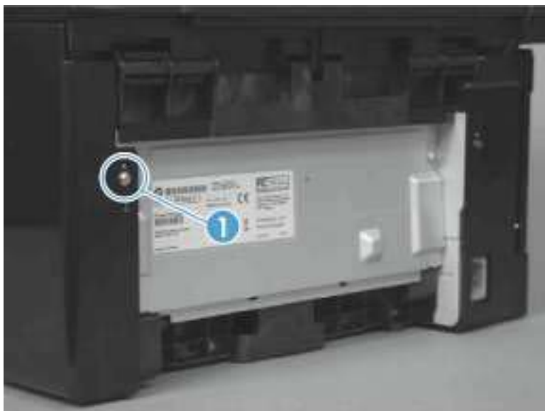
图 1-33 拆除右封盖（第 1 张，共 5 张）
