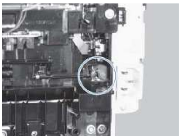
图 1-130 重新安装取纸装置（第 2 张，共 4 张，错误的接地弹簧位置）
