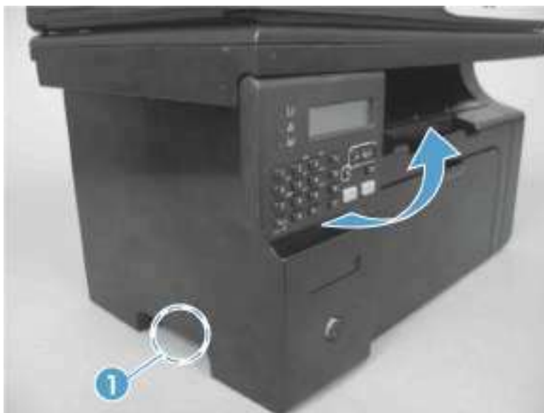
图 1-28 拆除左封盖（第 2 张，共 6 张）
