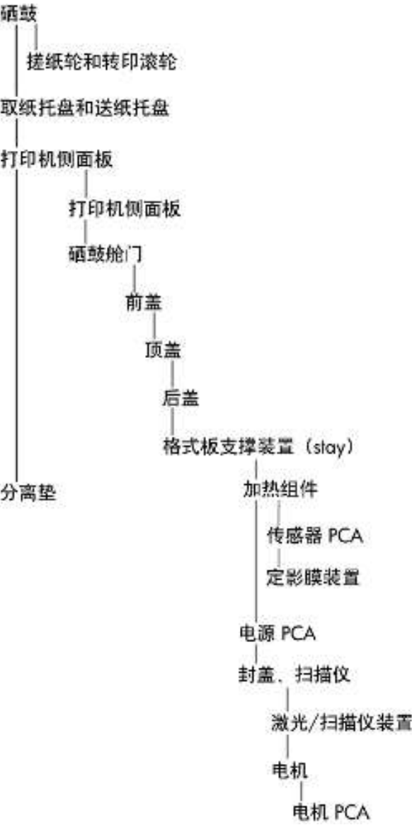
图 1-4 部件拆卸顺序，打印机主体
