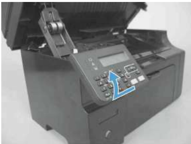
图 1-30 拆除左封盖（第 4 张，共 6 张）
