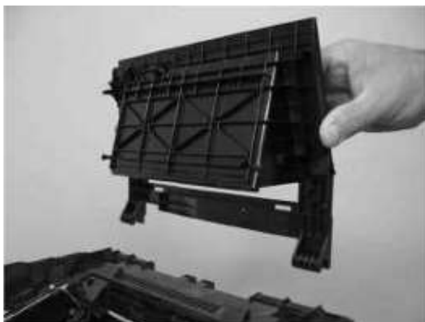
图 1-51 拆除硒鼓舱门（第 5 张，共 5 张）
