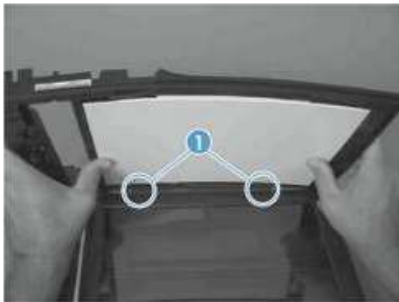
图 1-75 拆除 ADF 主体或扫描仪装置盖板（第 2 张，共 3 张）
