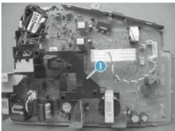
图 1-116 拆除加热组件（第 2 张，共 6 张）
