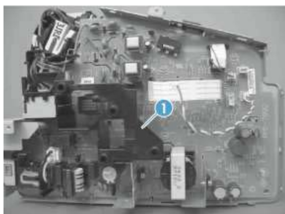
图 1-140 拆除引擎控制器 PCA（第 2 张，共 8 张）
