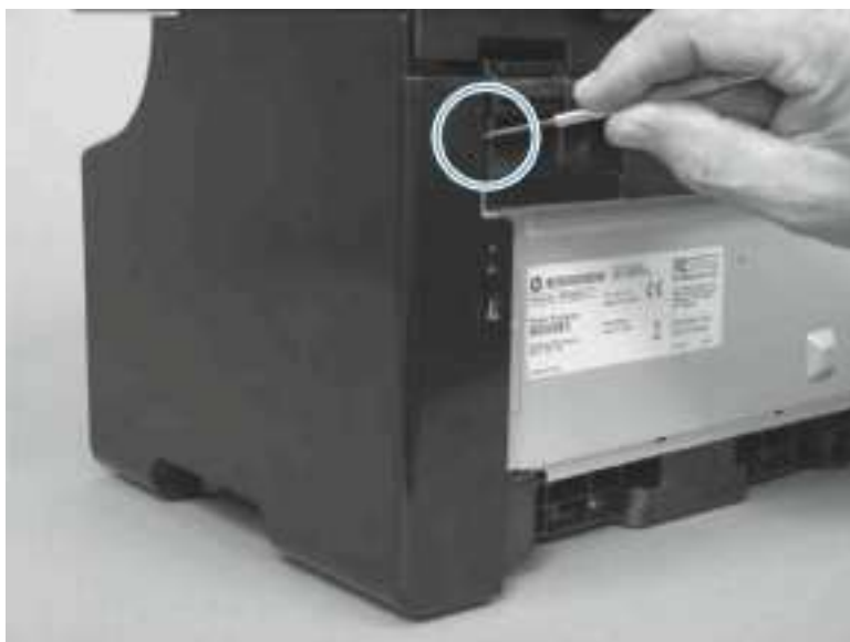
图 1-34 拆除右封盖（第 2 张，共 5 张）
