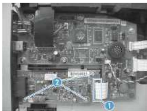
图 1-101 拆除传真 PCA
