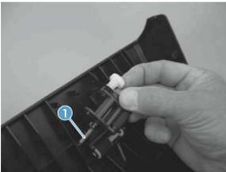
图 1-10 拆除 ADF 预取纸臂和搓纸轮装置（第 4 张，共 4 张）
