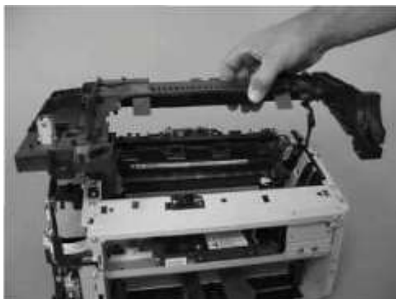
图 1-53 拆除顶盖（第 2 张，共 2 张）
