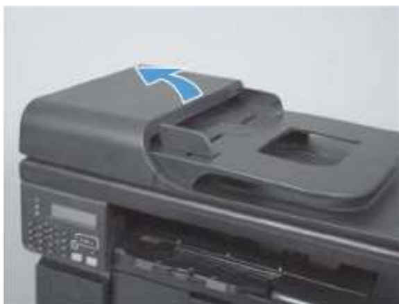
图 1-13 拆除 ADF 分离垫装置（第 1 张，共 4 张）
