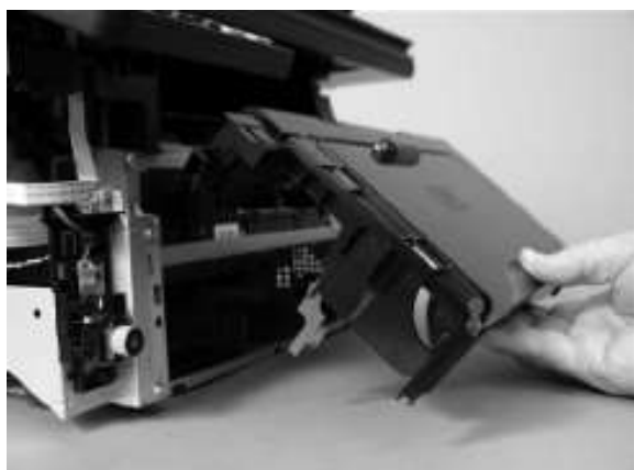
图 1-41 拆除前盖（第 4 张，共 4 张）
