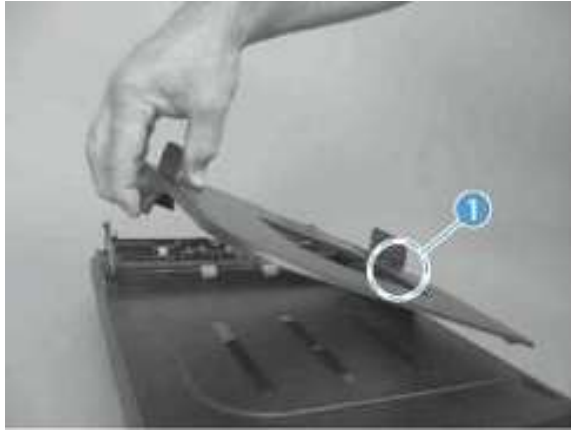
图 1-73 拆除 ADF 托盘（第 4 张，共 4 张）
