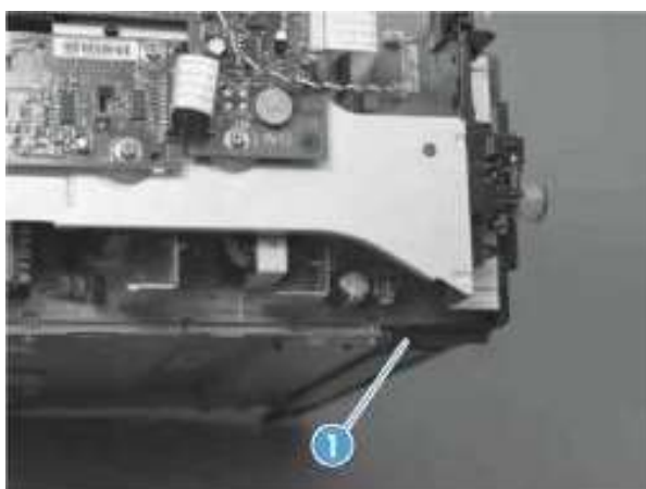
图 1-39 拆除前盖（第 2 张，共 4 张）
