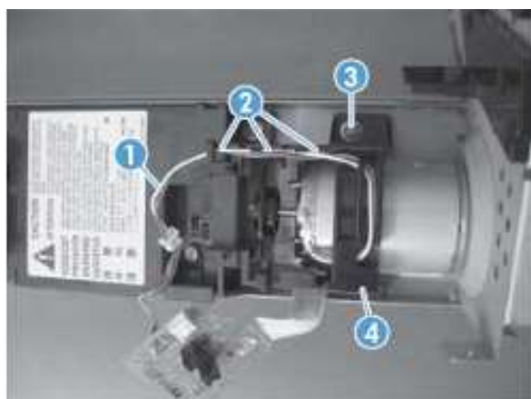
图 1-110 拆除主电机（第 5 张，共 7 张）
