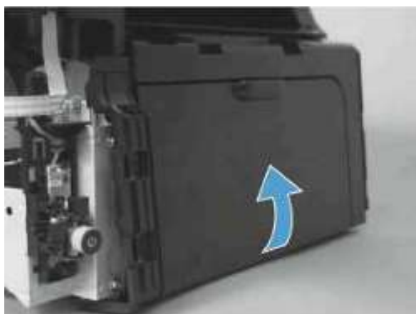
图 1-40 拆除前盖（第 3 张，共 4 张）
