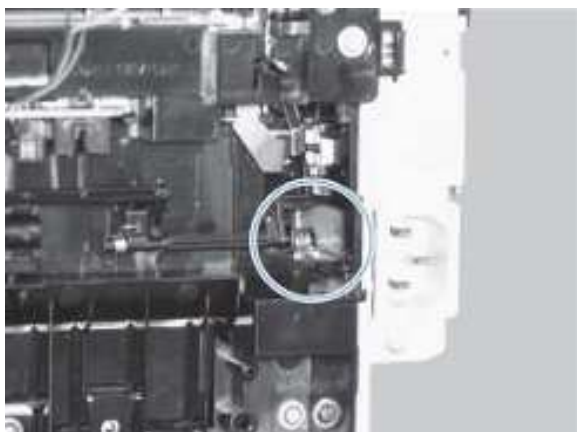
图 1-130 重新安装取纸装置（第 2 张，共 4 张，错误的接地弹簧位置）
