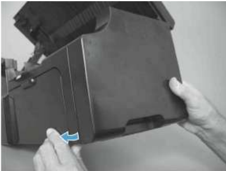
图 1-36 拆除右封盖（第 4 张，共 5 张）
