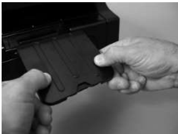
图 1-26 拆除送纸托盘（第 2 张，共 2 张）
