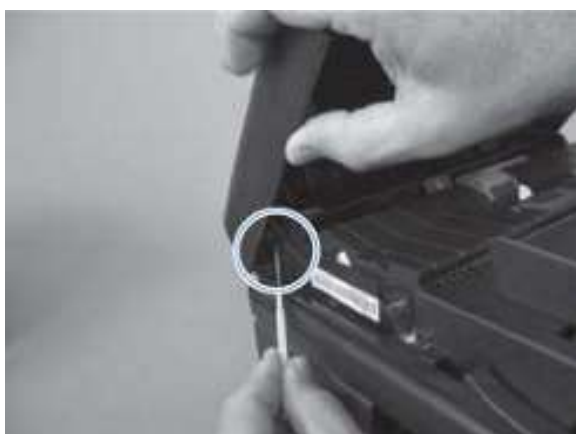
图 1-8 拆除 ADF 预取纸臂和搓纸轮装置（第 2 张，共 4 张）
