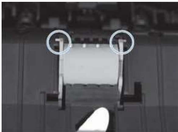
图 1-20 重新安装 ADF 分离垫装置（第 4 张，共 5 张）
