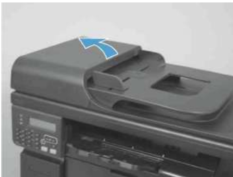
图 1-7 拆除 ADF 预取纸臂和搓纸轮装置（第 1 张，共 4 张）
