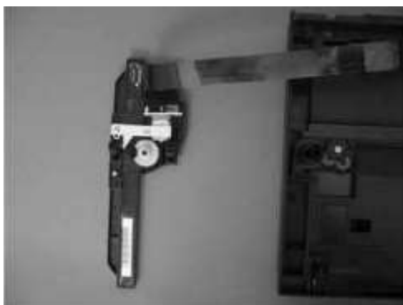
图 1-82 拆除 CIS 扫描仪电机、齿轮和扫描仪光条（第 1 张，共 4 张）
