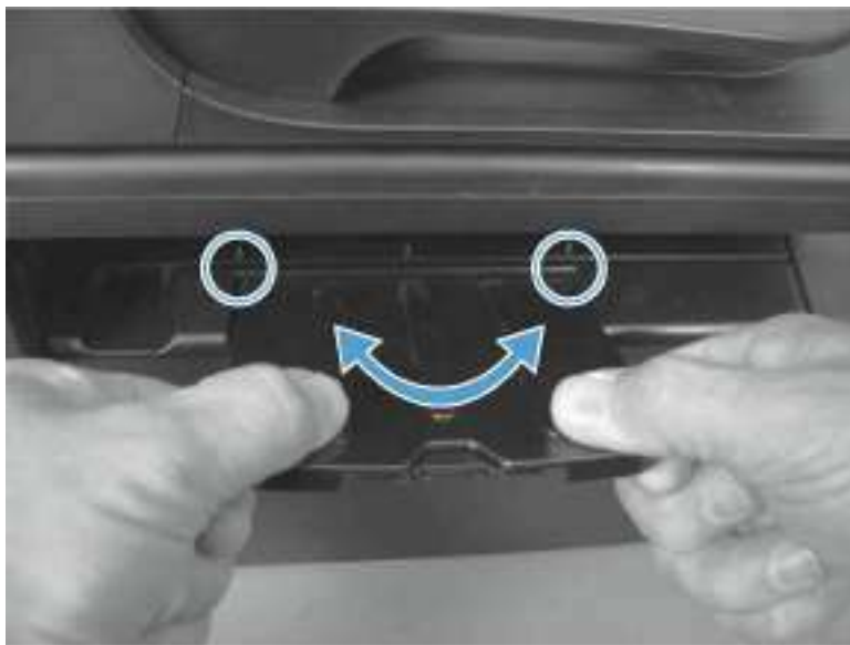
图 1-25 拆除送纸托盘
