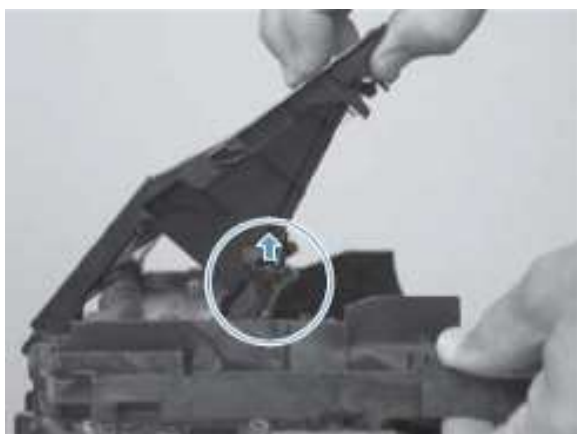
图 1-48 拆除硒鼓舱门（第 2 张，共 5 张）
