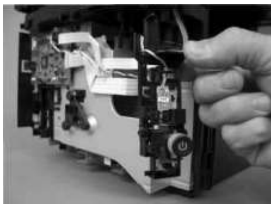
图 1-96 拆除电源开关装置（第 3 张，共 3 张）
