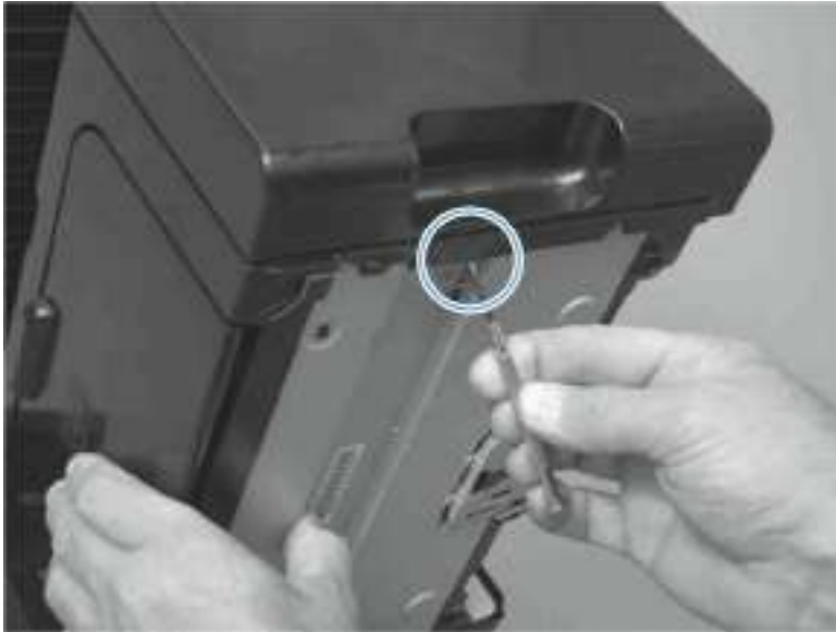
图 1-36 拆除右封盖（第 4 张，共 5 张）
