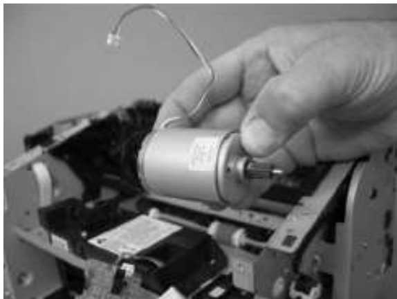
图 1-112 拆除主电机（第 7 张，共 7 张）
