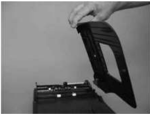
图 1-73 拆除 ADF 托盘（第 4 张，共 4 张）
