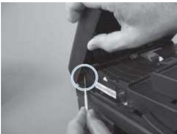
图 1-14 拆除 ADF 分离垫装置（第 2 张，共 4 张）
