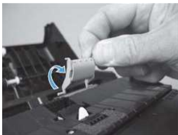
图 1-16 拆除 ADF 分离垫装置（第 4 张，共 4 张）
