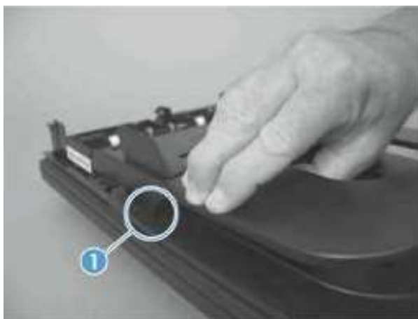
图 1-71 拆除 ADF 托盘（第 2 张，共 4 张）
