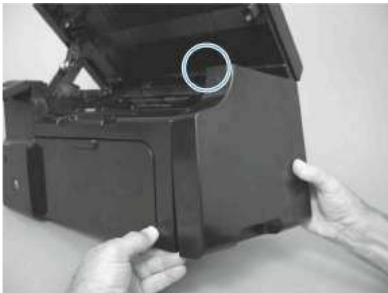
图 1-37 拆除右封盖（第 5 张，共 5 张）
