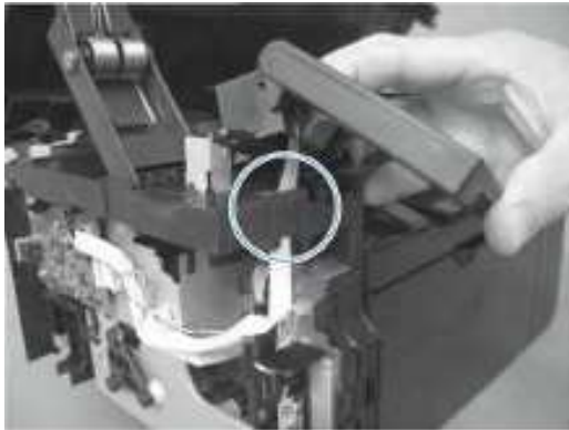
图 1-93 重新安装控制面板装置（第 2 张，共 2 张）
