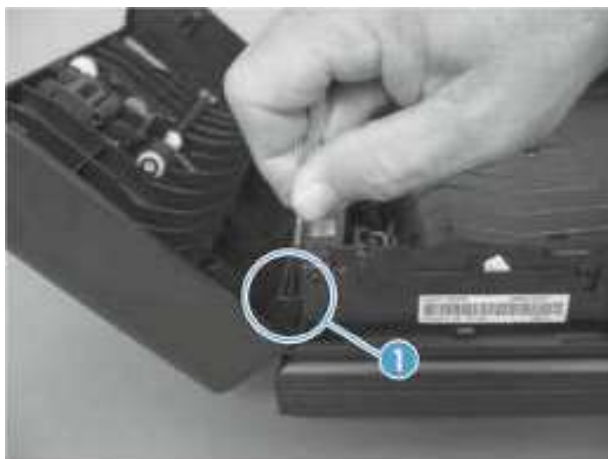
图 1-63 拆除 ADF 顶盖（第 3 张，共 4 张）
