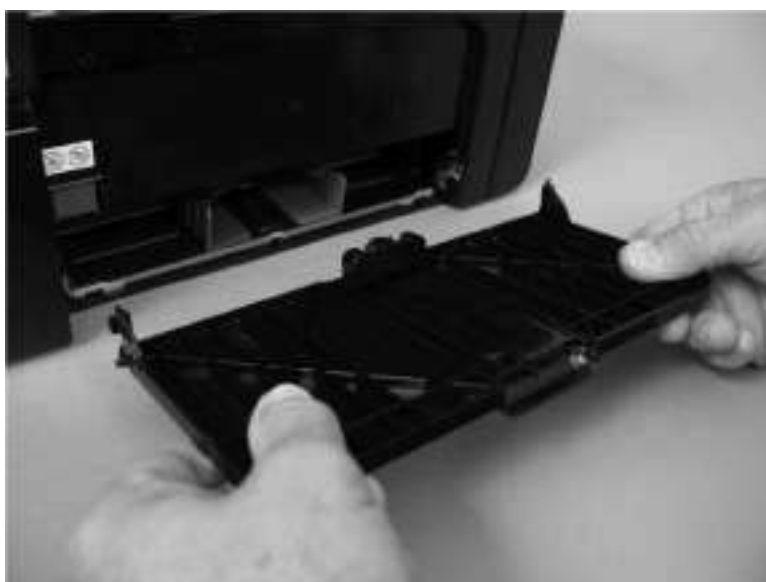
图 1-24 拆除取纸托盘（第 2 张，共 2 张）
