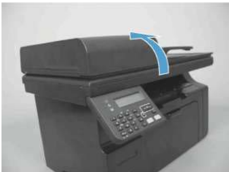
图 1-30 拆除左封盖（第 4 张，共 6 张）
