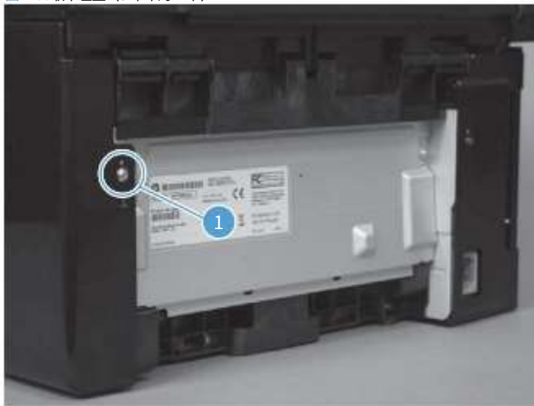
图 1-33 取下左盖 (5 个中的 1 个)
