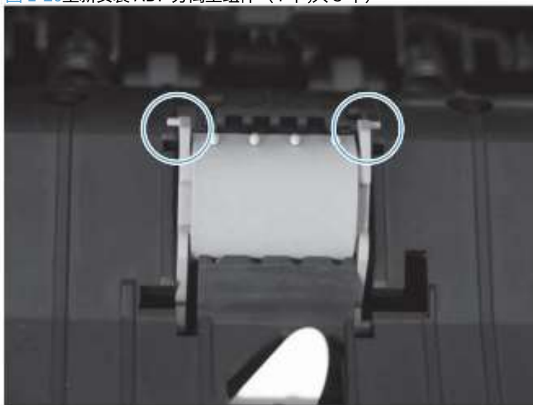
图 1-20 重新安装 ADF 分离垫组件 (4 个,共 5 个)
