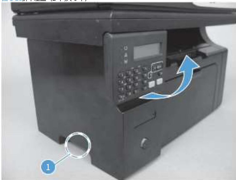
图 1-28 拆下左盖 (2 个, 共 6 个)
