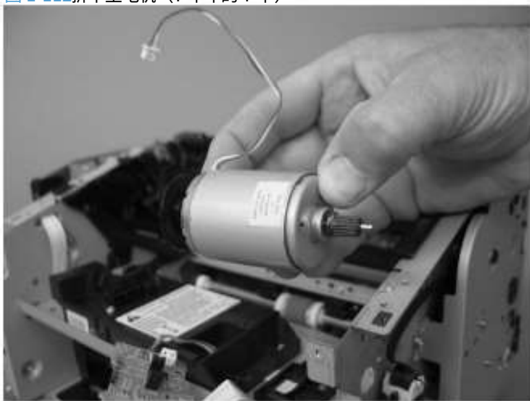
图 1-112 拆下主电机（7 个中的 7 个）
