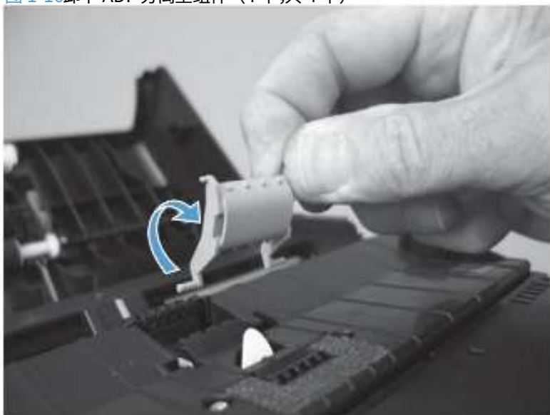
图 1-16 卸下 ADF 分离垫组件 (4 个,共 4 个)
