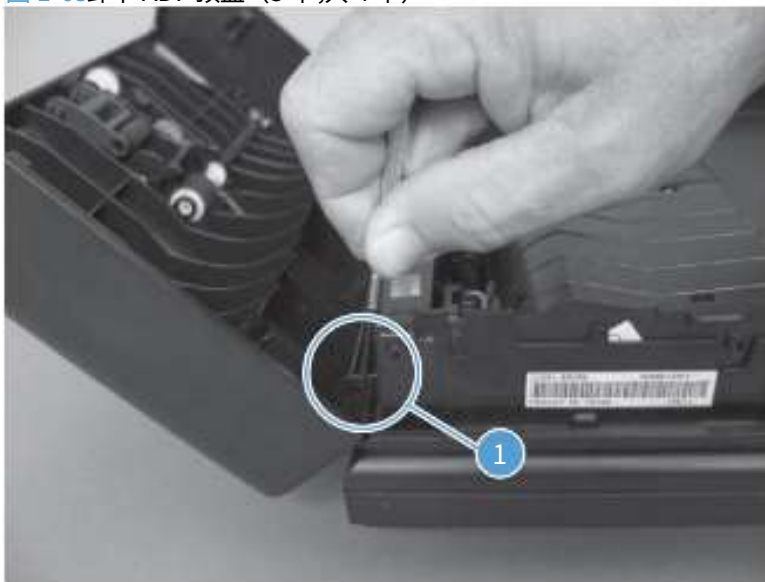
图 1-63 卸下 ADF 顶盖 (3 个, 共 4 个)
