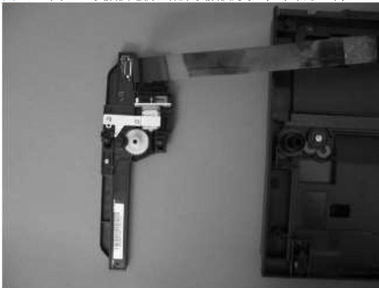
图 1-82 卸下 CIS 扫描仪电机、齿轮和扫描仪灯条 (4 个中的 1 个)
