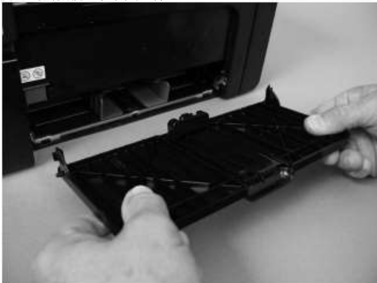
图 1-24 取出取纸托盘 (2 个中的 2 个)
