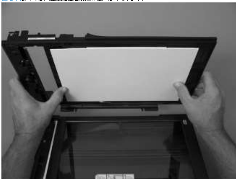
图 1-76 卸下 ADF 底座或扫描仪组件盖（3 个,共 3 个）
