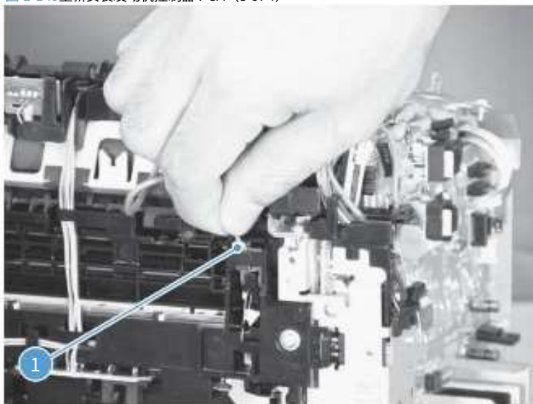
图 1-149 重新安装发动机控制器 PCA (3 of 4)
