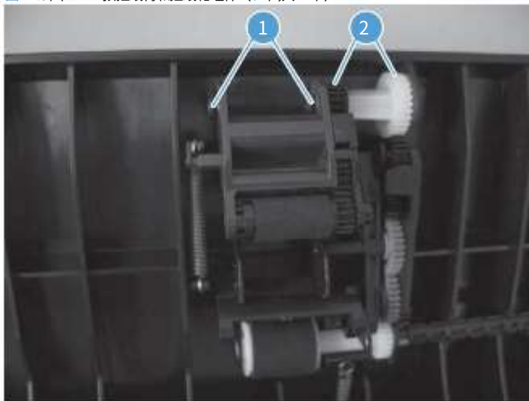
图 1-9 卸下 ADF 预搓纸臂和搓纸轮组件（3 个, 共 4 个）
