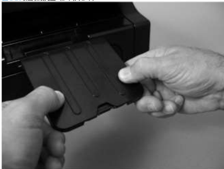
图 1-26 取出取纸托盘（2 个,共 2 个）
