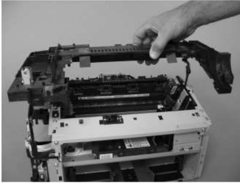
图 1-53 卸下顶盖 (2 个中的 2 个)
