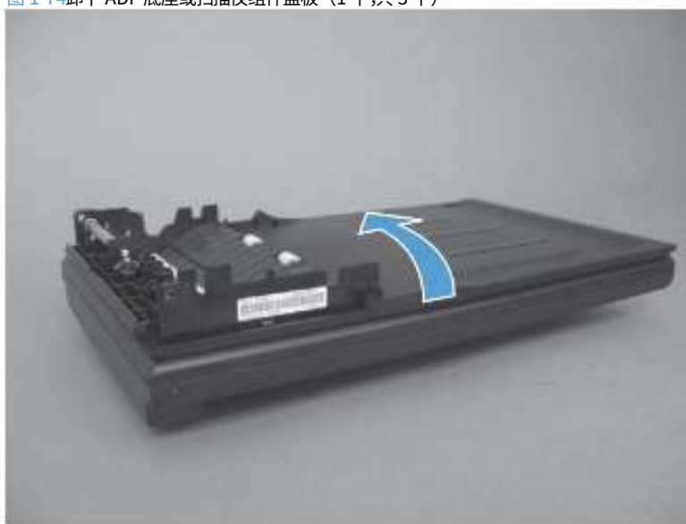
图 1-74 卸下 ADF 底座或扫描仪组件盖板 (1 个,共 3 个)
