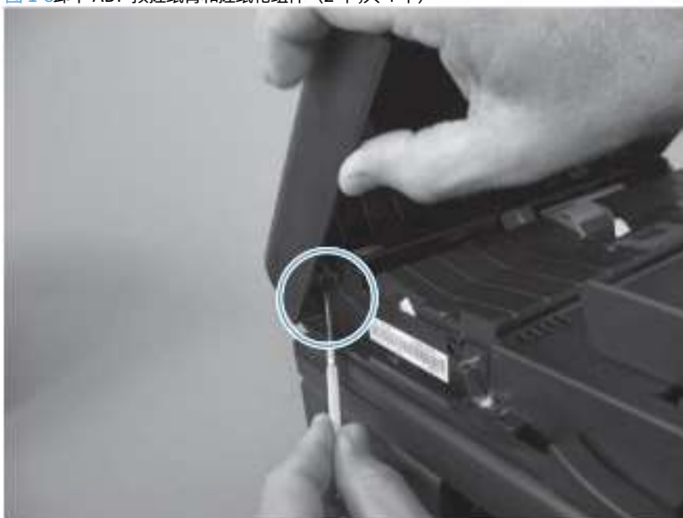
图 1-8 卸下 ADF 预搓纸臂和搓纸轮组件 (2 个, 共 4 个)
