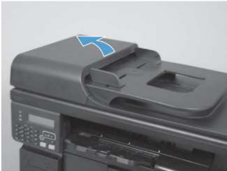
图 1-13 卸下 ADF 分离垫组件 (1 个,共 4 个)
