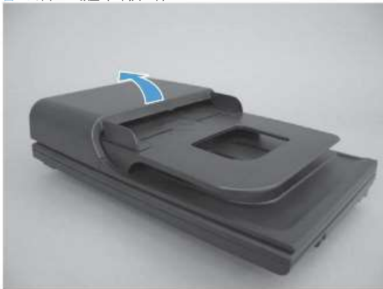
图 1-61 卸下 ADF 顶盖 (1 个, 共 4 个)
