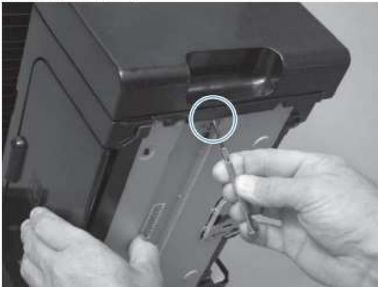
图 1-35 拆下右盖 (3 个, 共 5 个)
