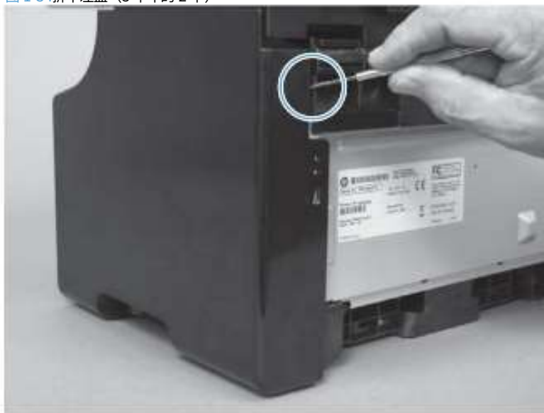
图 1-34 拆下左盖 (5 个中的 2 个)
