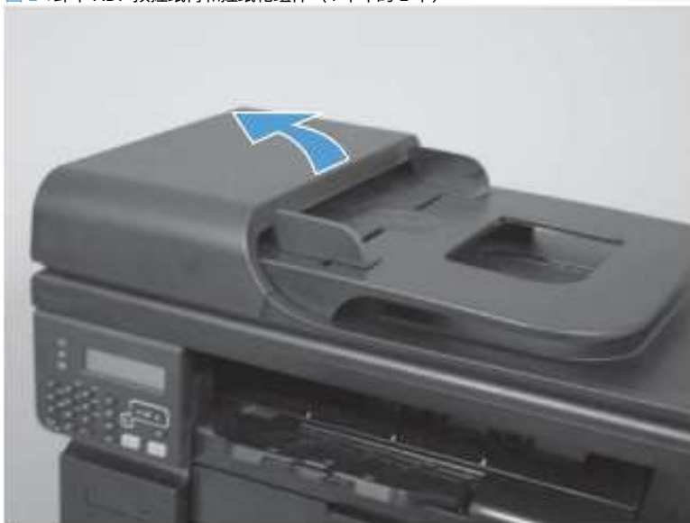
图 1-7 卸下 ADF 预搓纸臂和搓纸轮组件 (4 个中的 1 个)
