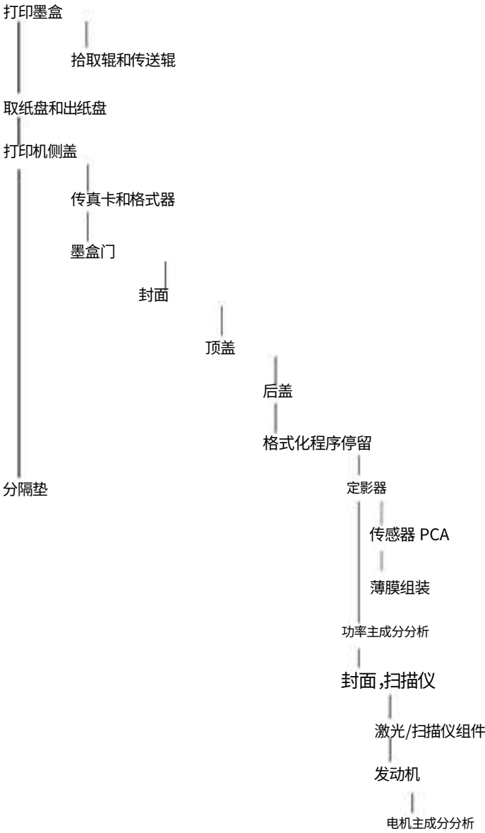
图 1-4零件拆卸顺序;产品基础
