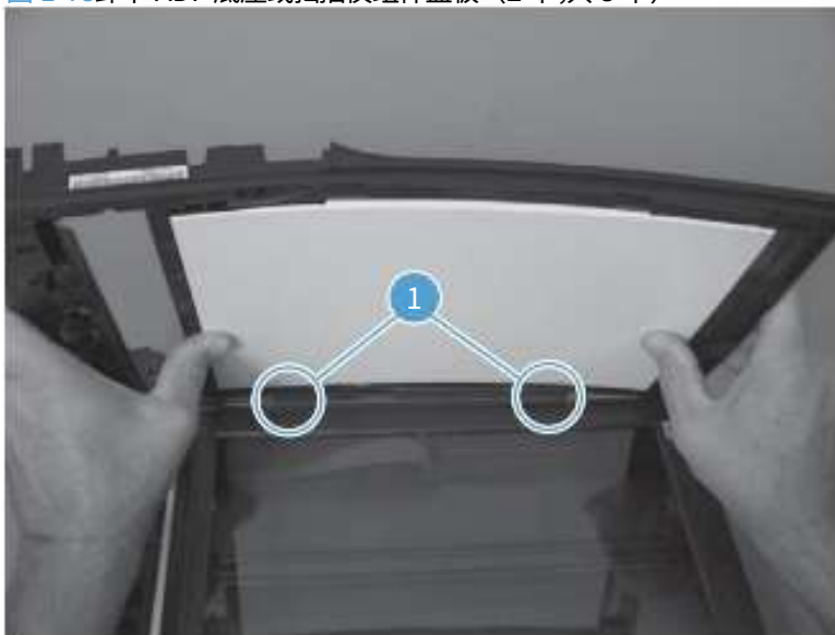
图 1-75 卸下 ADF 底座或扫描仪组件盖板（2 个,共 3 个）
