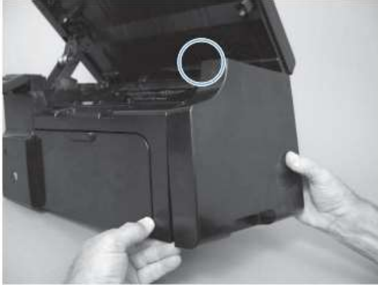
图 1-37 卸下右盖 (5 个中的 5 个)
