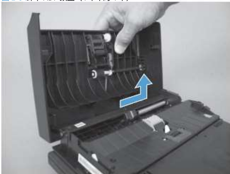
图 1-64 卸下 ADF 顶盖 (4 个中的 4 个)
