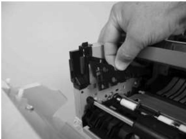
5. 拧下上一步拆除的导线槽附近的三枚螺钉（插图编号 4）。
