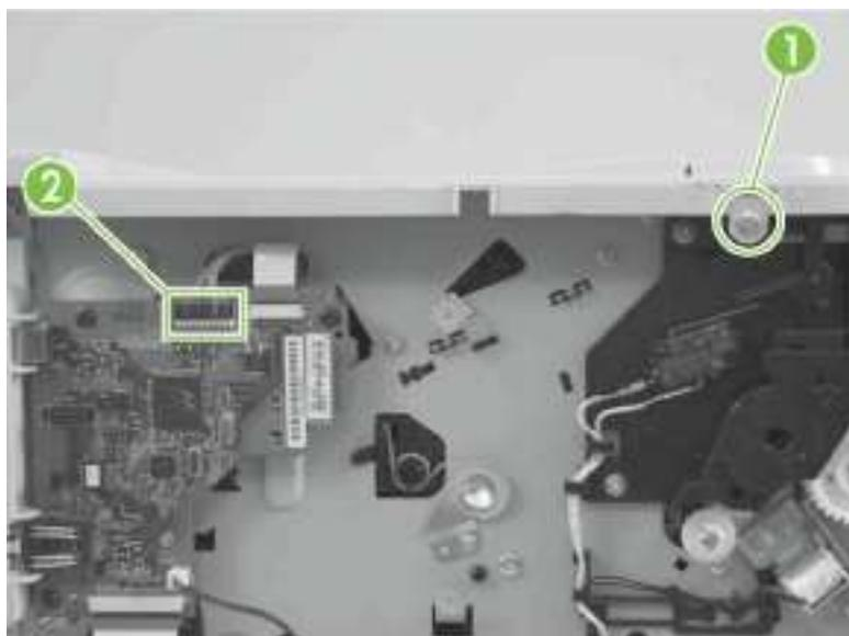
图 6-40 拆卸顶盖组件（第 2 步，共 4 步；只针对 HP LaserJet P2050 系列）
