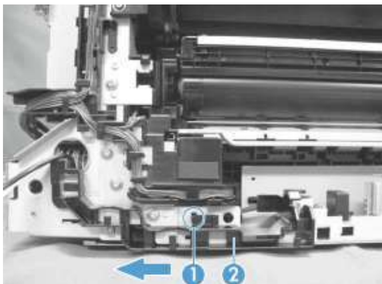
图 1-81 拆卸定影器电源（第 3 步，共 4 步）
