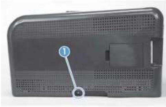
3. 小心地向外扳动打印机右盖板的前端，松开 1 个突舌。
