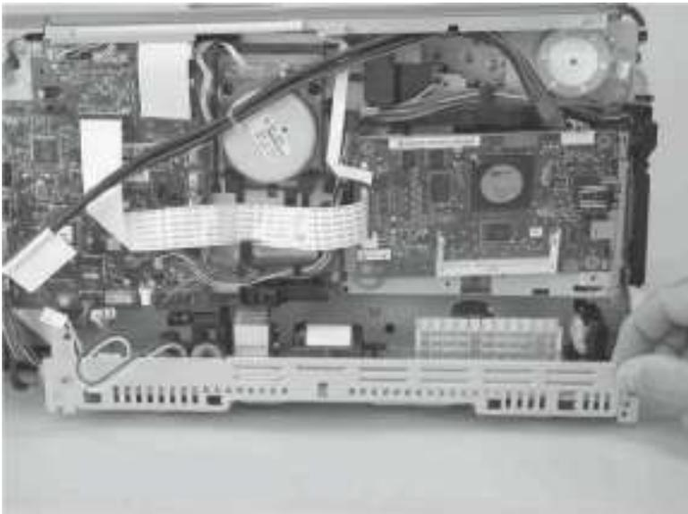
11. 向外旋转电源接近控制面板模块的一端，让其远离打印机，为机箱空出一些空间，然后朝控制面板模块的方向滑动电源，将其卸下。
