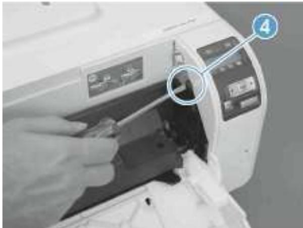
5. 向外旋转控制面板模块的顶部，将其从打印机上卸下。
