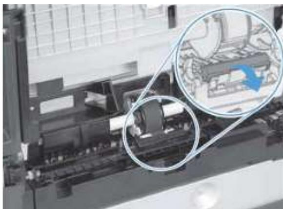
3. 使用小平头螺丝刀轻轻地撬起分离滚轮和固定器装置（编号 1），将其卸下。
