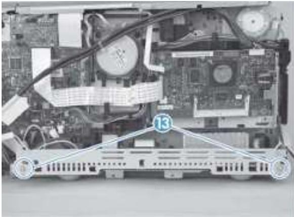
10. 使电源远离机箱（无法将其完全取出）。
