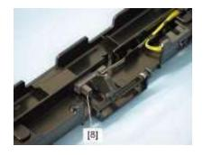
4、断开一个连接。释放卡扣并取出 DSDF 托盘提升下限传感器[9]
