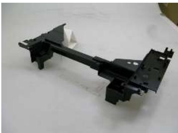
9) 拆卸副机架单元和 ASF 盖板。
