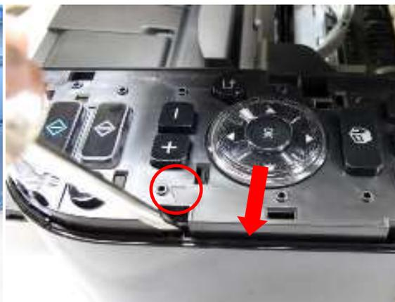
在标记 ▼ 的位置，如图中红色标识圈所示，向外推侧盖卡口，然后移除侧盖。
