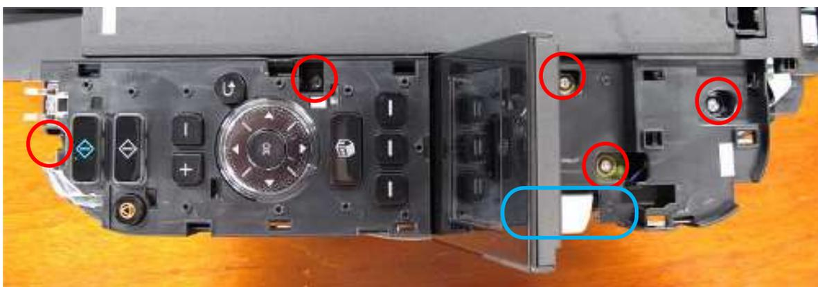
松开控制板面上的 5 个螺丝。
