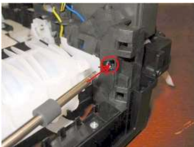
5) 对于进纸辊单元，安装进纸皮带和轴衬，然后将其安装到主单元。
