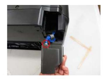
3) 拆卸控制面板左前方盖板 (没有螺丝)。 <从打印机的正面向外滑动盖板。>
