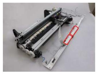
3) 在主机底盘上,标记小车上导轨的位置(导轨的左右边缘的位置)。
