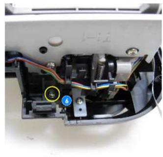
将打印机单元从底架分离时,可以更换废墨吸收垫。
