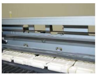
6) 拆卸条形编码器。小心操作,以免薄膜沾染润滑剂或受到损害。
