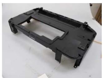
5) 拆卸右控制板盖单元 (1 个螺丝)。
