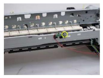
2) 从刺轮座单元的左右两侧释放弹簧 (每侧1个弹簧)。
