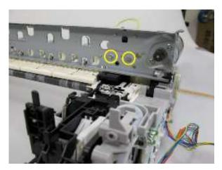
2) 从开关系统单元拆下 3 个螺丝。
