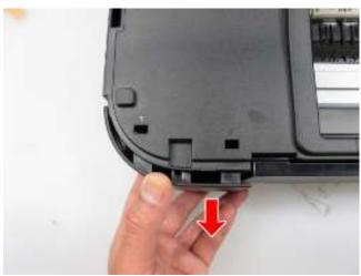
4) 拆卸主机架 (2 个螺丝)。 <向上抬起主机架使其与打印机分离。>
