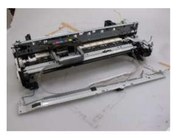
9) 拆卸小车单元。小心操作,以免任何部件沾染润滑剂。
