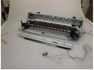
4) 解锁出纸辊齿轮。抬起压盘单元前部的同时,从打印机单元中拆卸下压盘单元。
