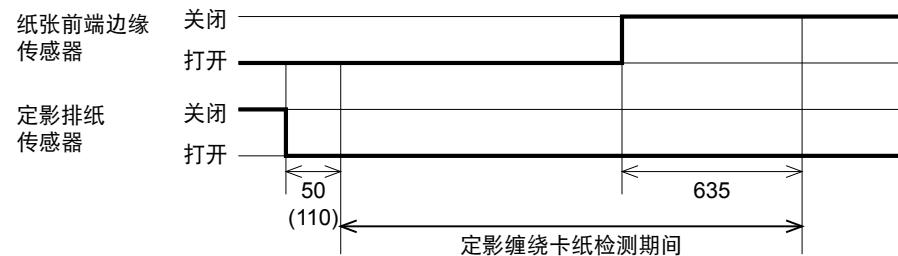
如果在定影排纸传感器 (PS701) 检测到有纸张后的 50 毫秒和纸张前端边缘传感器 (PS751) 检测到没有纸张后的 635 毫秒之间定影排纸传感器 (PS701) 检测到没有纸张，确定为定影缠绕卡纸。
