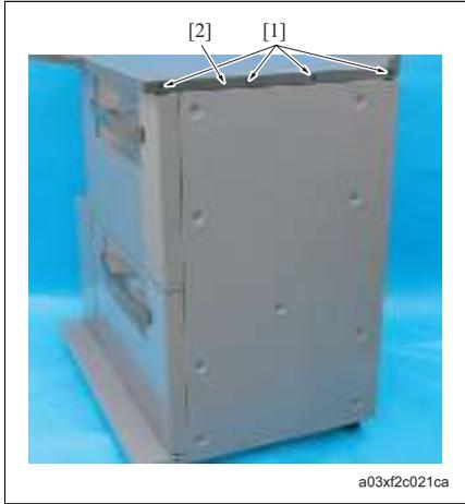
1. 卸下 4 颗螺钉 [1]，然后卸下右盖板的固定板 [2]。
