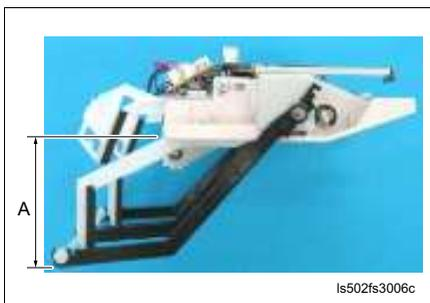
1. 用手开启纸张加压电磁铁 / 3 (SD8)，检查左图中 A 段距离是否为  $50.1 \pm 1 \text{ mm}$ 。
