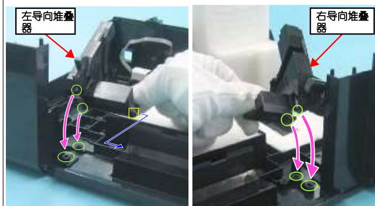
图1-65。 安装左/右导板堆叠器
