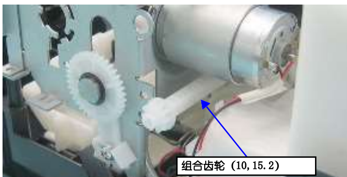
图1-56 拆卸组合齿轮（10, 15, 2）
