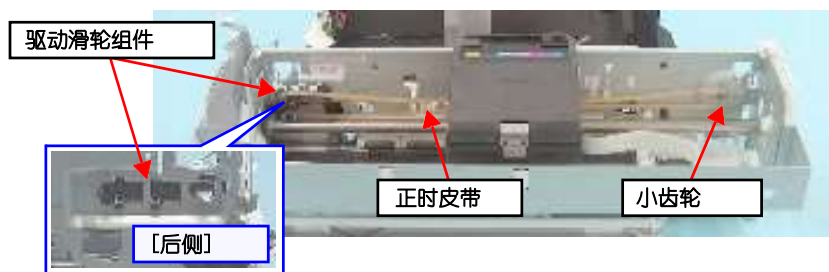
图1-83. 拆卸CR电机 (1)
