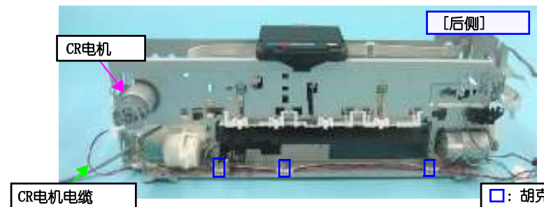
图1-84. 拆卸CR电机 (2)
