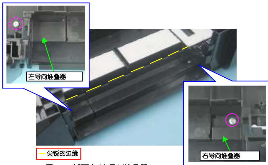
图1-64 卸下左/右导板堆叠器
