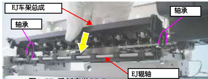
图1-77 重新安装EJ Frame Assy
