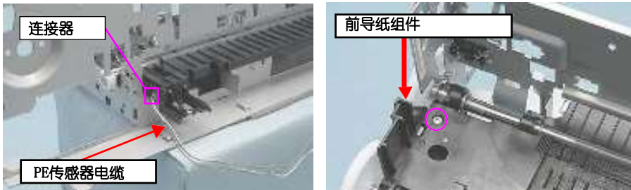
图1-107。卸下PE传感器电缆
