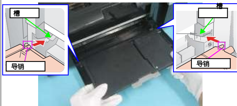
图1-19。安装堆叠器组件
