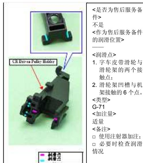
图 4-11 字车皮带驱动滑轮的润滑
