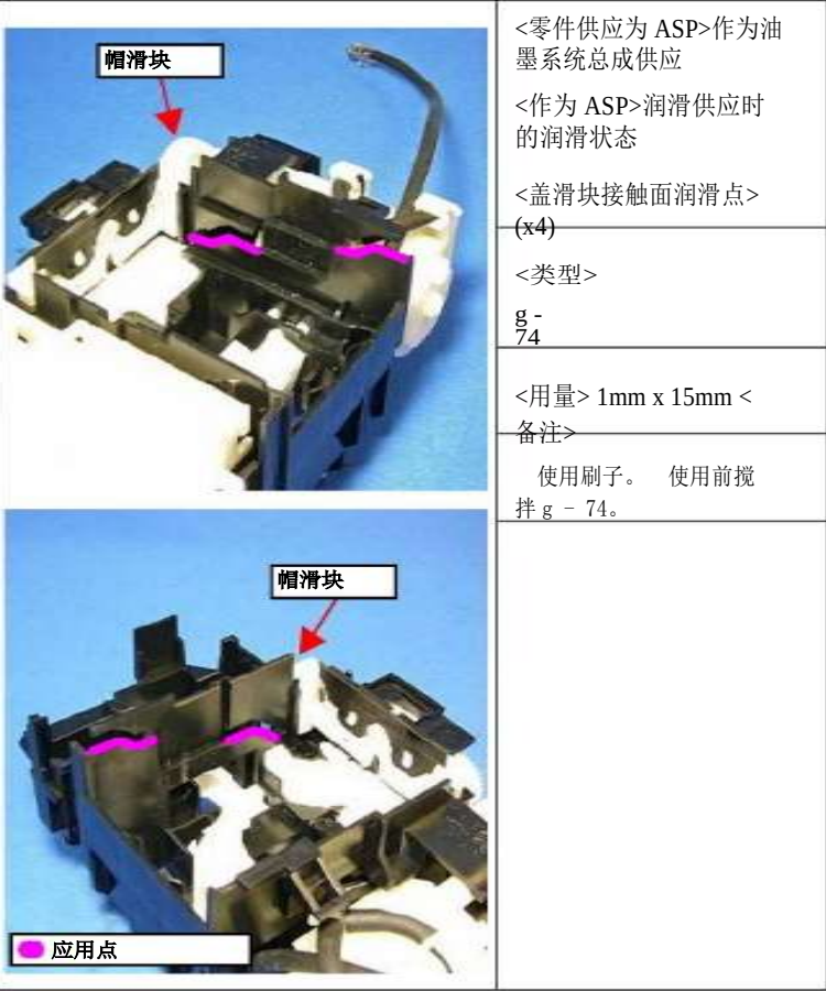
图 4 - 7。油墨系统总成的润滑(1)
