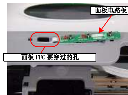
图 2-5. 面板电路板的安装
