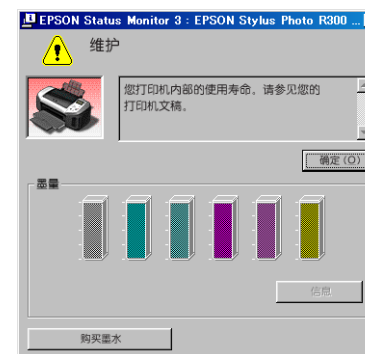
图 4-3. 显示在 Status Monitor 3 中的维护请求错误
