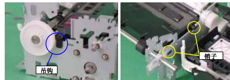
图 2-48. 前端导纸板的安装
