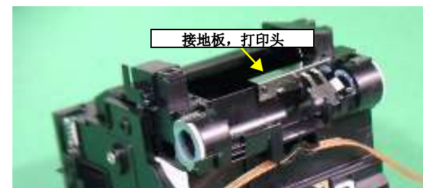
图 2-27. “接地板、打印头”的安装位置
