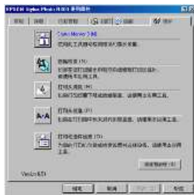
图 4-2. 打印驱动程序中的打印头清洗功能
